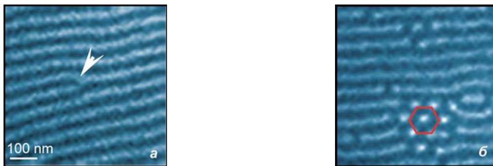
Рис. 2: а) Полосовая геликоидальная спиновая структура, спонтанно образующаяся в Fe_{0.5}Co_{0.5}Si б) Появление гексагональной решетки вихрей во внешнем поле 20 мТл (элементарная ячейка показана красным цветом)
